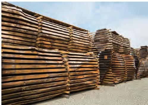
製材した板は、含水量(板が含む水分の量)を計算しながら、2年～10年自然乾燥させます。
