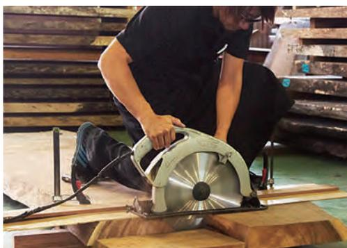
木取りの作業で決められた製品サイズに板をカットします。両端を平行に切り出すには熟練の技術が必要で、この工程の良し悪しで製品の品質が決まります。
