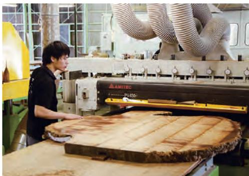
何回も機械に通して板の表面を削り、平らにします。アトリエ木馬の機械は長さ12mまで加工でき、大自然のスケールを損ないません。
