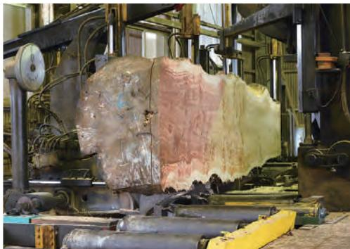
製材機に乗せ回転させながら、年輪や木材の状態を確認します。
