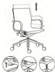
レバーを上に引くと、座面が昇降します。
